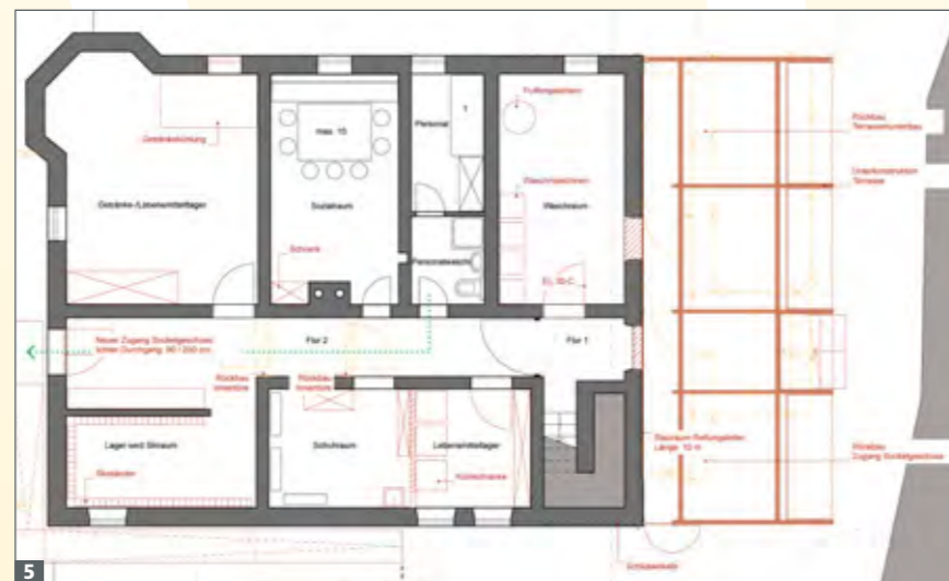
5 Grundriss des Sockelgeschosses der Oberlandhütte
